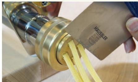
Nun wird die gewünschte Matrice eingesetzt und die Maschine auf „Pressen“ geschaltet. Mit einem Teigschaber oder Messer die Nudeln, während des Pressvorgangs, auf die gewünschte Länge abschneiden.
