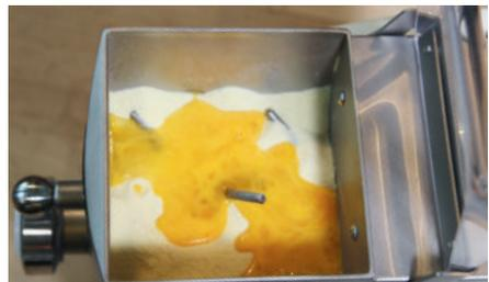
Ca. 1/3 der Eimenge/Wasser in die Maschine gießen. Den Deckel schließen, auf „Mischen“ schalten und ca. 1 Minute mischen lassen.
