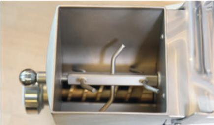
Blick von oben in die Nudelmaschine LUNA mit eingesetztem Mischarm und Auspreßspirale.
